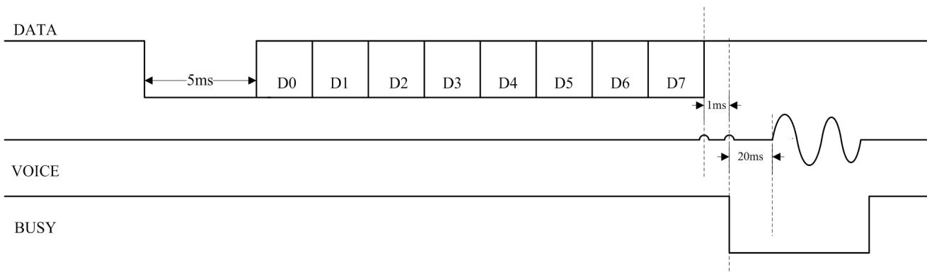
先把数据线拉低 5ms 后，发送 8 位数据，先发送低位，再发送高位，使用高电平和低电平比例来表示每个数据位的值。
