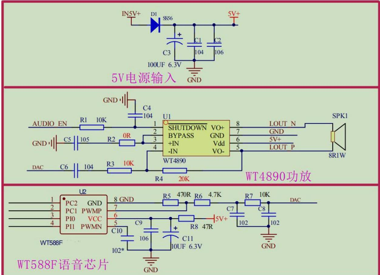
注:可以用WT588F芯片的第一脚来使能功放芯片, 语音芯片不播放时第一脚为高电平, 播放时为低电平 (需根据功放使能状态做相应的电平转换); 也可以用单片机来使能功放芯片或外接电源一直使能功放芯片。
