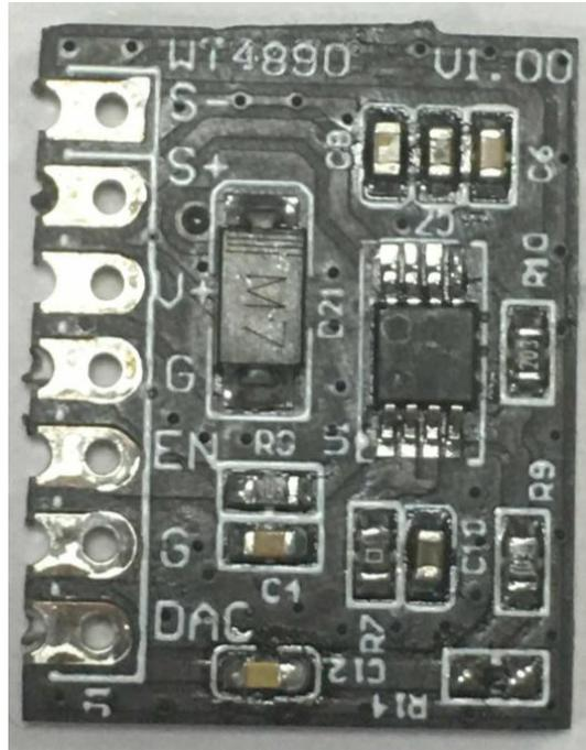
1. S+、S-脚为模块的音频输出脚，外接喇叭，可外接 $8\Omega$  1W的喇叭。
