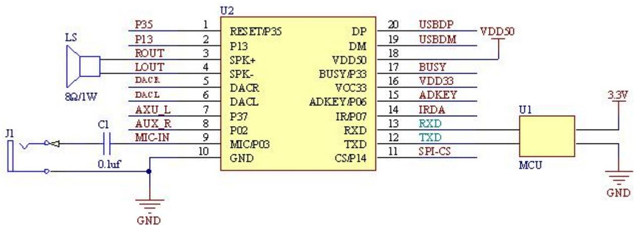
注意：1. WT2605B02 是 3.3V IO 系统，可以直接与 3.3V MCU 连接。与 5V 单片机连接需要增加电平转换电路。
